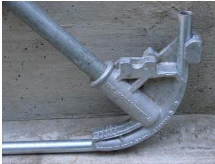
شكل رقم ٨٢: جهاز الثني المستخدم لثني المواسير
