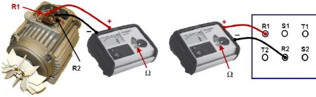
شكل رقم ١٠٥: قياس استمرارية التوصيل في محرك كهربائي باستخدام جهاز الميكر
