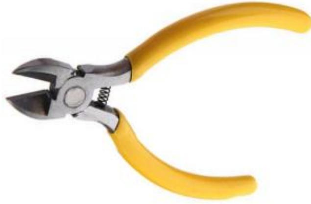
شكل رقم ٢٢: زردية القطع - القصافة (Cutter Plier)
