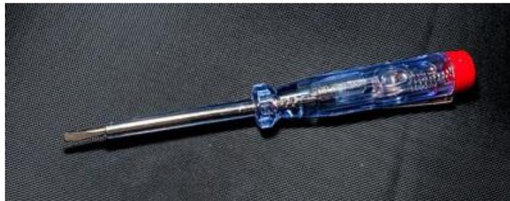
شكل رقم ٢٨: صورة لمفك اختبار
