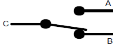
شكل رقم ٤: مفتاح أحادي القطبية ثنائي الخرج
