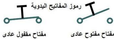
شكل رقم ٣: رموز المفاتيح اليدوية
