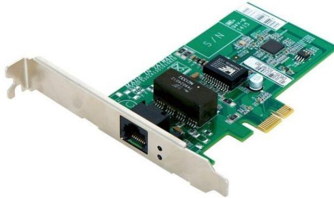
شكل رقم ٣٠: شكل بطاقة (كارت) الشبكة
