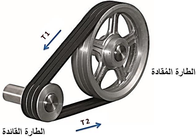
شكل رقم ٢١: القدرة المنقولة بالسيور
