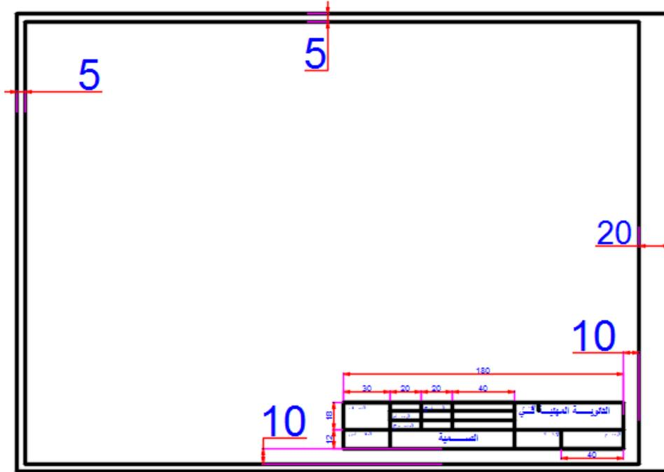
شكل رقم ٥٤: بطاقة تعريف الرسم
