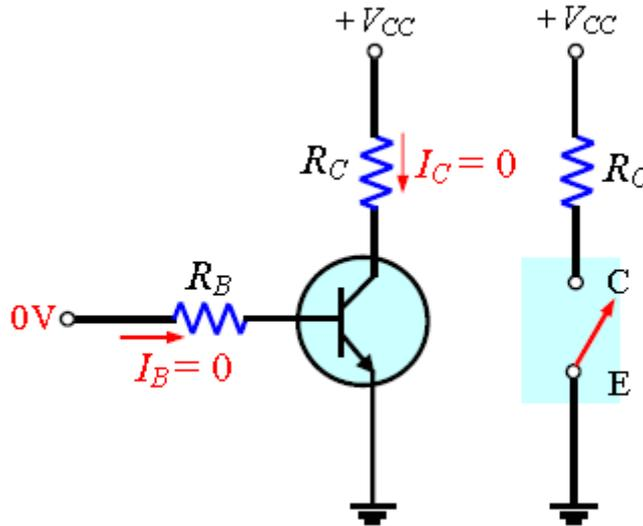
شكل رقم ٣٦: استخدام الترانزستور للعمل كمفتاح مفتوح
