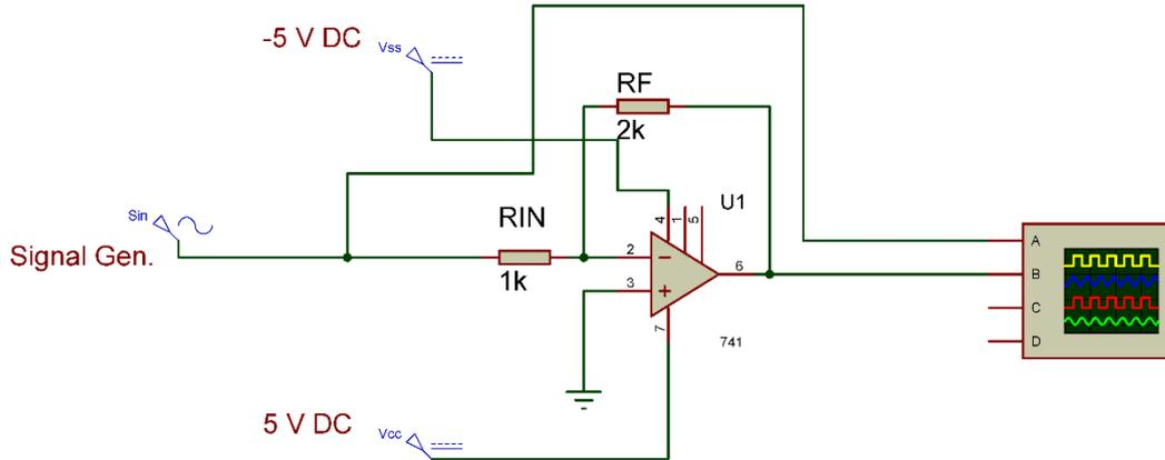
شكل رقم ٩٥: دائرة المكبر العاكس باستخدام الدائرة المتكاملة (IC Op Amp 741)
