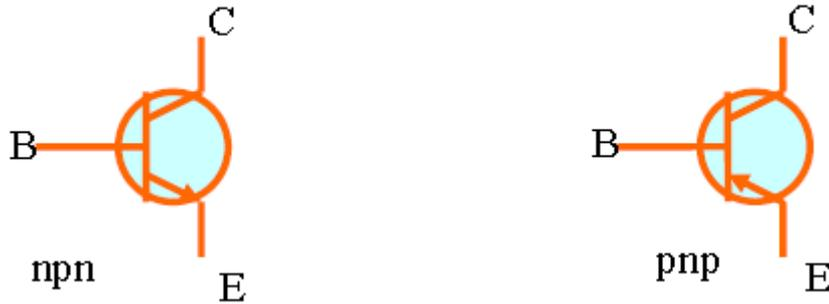
شكل رقم ٢٩: الرمز القياسي لكل من الترانزستور NPN والترانزستور PNP
