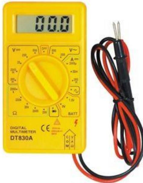
شكل رقم ١٥٤: جهاز قياس متعدد الأغراض (AVO)
