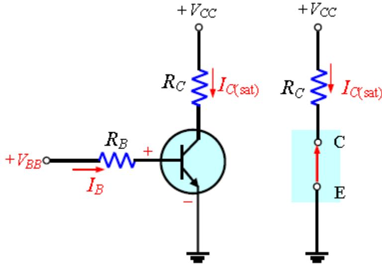
شكل رقم ٣٧: استخدام الترانزستور للعمل كمفتاح مغلقة
