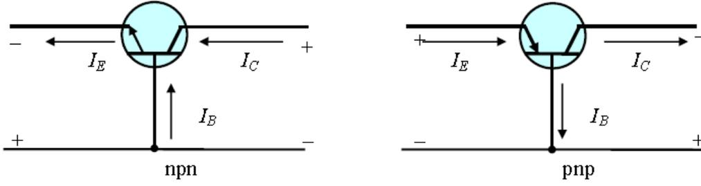
شكل رقم ٣٣: تيارات الترانزستور
