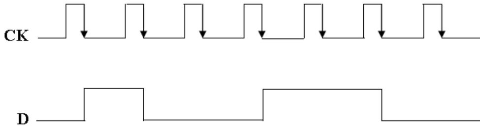
٩. أرسم شكل نبضات الخرج (Q) لدائرة القلاب (JK) والتي يتغير الخرج لها عند الحافة الموجبة لنبضات التزامن (Negative edge trigger) إذا كان شكل نبضات الدخل كما هو موضح بالشكل التالي. افترض أن دائرة القلاب تعطى خرجا  $Q=0$  قبل وصول أول نبضة من نبضات التزامن.
