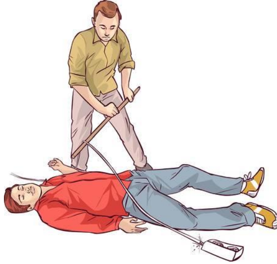
شكل رقم ٥٣: استخدام العصا الخشبية لرفع ناقل الكهرباء عن المصاب
