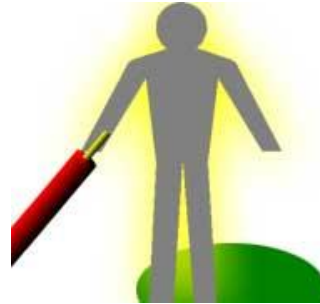
شكل رقم ٤٧: الصدمة الكهربائية عن طريق الإتصال بالموصل الحامل للتيار
