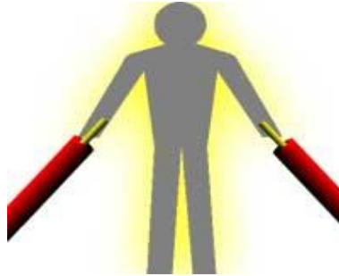
شكل رقم ٤٦: الصدمة الكهربائية عن طريق الإتصال بكلتا الوصلتين
